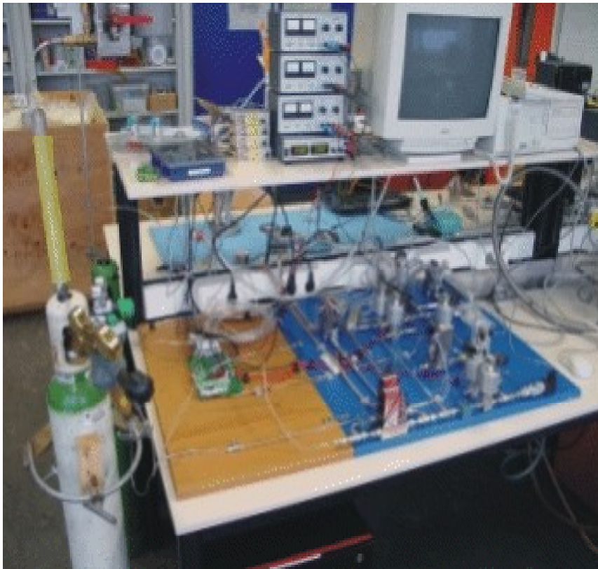
Testopstelling van het koelsysteem.
